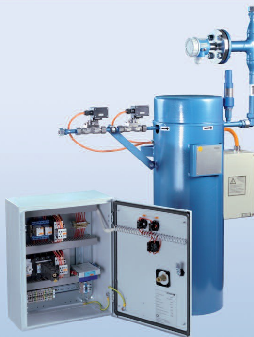
Ammoniakförångare med vätskevakt Typ ETA Indirekt elektriskt värmd 5-30 kg/h
